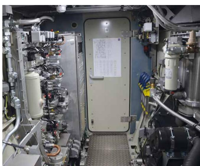
Pohľad do strojovne Vectrona. Rušňovodič môže na rozdiel od iných elektrických rušňov bezpečne vstúpiť dnu aj keď má vozidlo pod trolejom zdvihnuté zberače.
