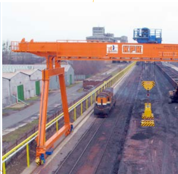
Portálový žeriav. Gantry crane.
