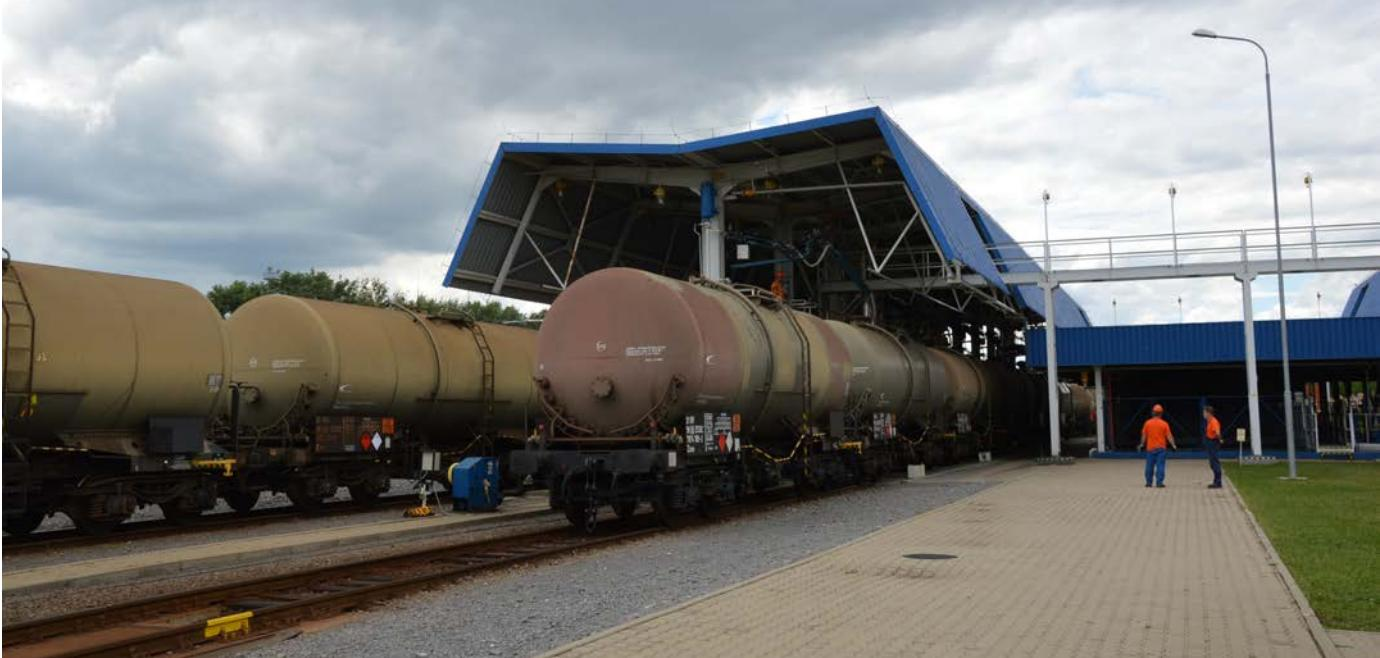
Zrekonštruovaný prečerpávací komplex slúži v Čiernej nad Tisou od roku 2009. Dajú sa v ňom súčasne prečerpávať kvapalné substráty z 8 vozňov širokého rozchodu do 8 vozňov normálneho rozchodu.
