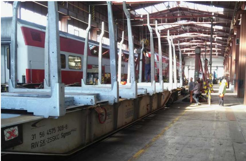
Montáž klanicových paliet na vozne Sgnss v Opravovni nákladných vozňov Žilina.
