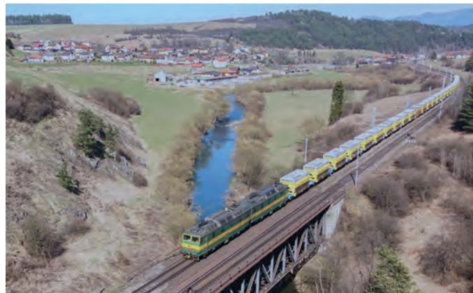
Prepravu súprav s dvojčlánkovými vozňami, na ktorých sú umiestnené nové kontajnery na rudu, zabezpečuje ZSSK CARGO dvojčkami, rušnami radu 131. Záber je z 10. apríla v Smižanoch. (Foto: Miroslav BELAY).
