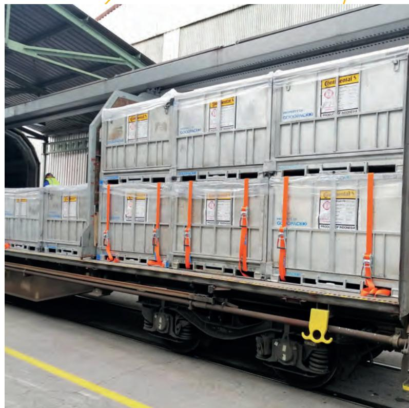
Od začiatku roka do konca marca sa po železnici do Púchova prepravilo 11 115 ton prírodných a syntetických kaučukov. Zmesi sa prepravujú v špeciálnych nádržach vo veľkokapacitných krytých vozňoch radu H.
