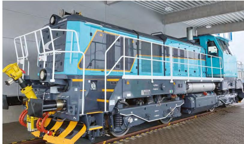
Dôležitým aspektom modernizácie je aj prínos z pohľadu ekológie a znížovania uhlíkovej stopy a emisií skleníkových plynov. HDV splňa emisnú normu EU STAGE IIIA, jeho hlučnosť a vibrácie sú nižšie ako u pôvodného HDV.
