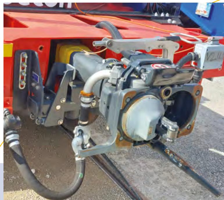
Digitálne automatické spriahadlo umožňuje prenos dát a ďalší pokrok v digitalizácii a automatizácii prevádzky.
