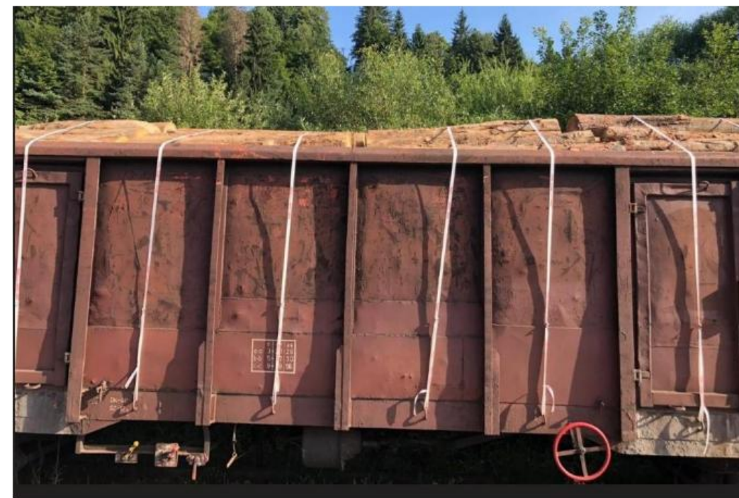
Obr. č. 25. Správny spôsob zaistenia drevnej gulatiny vo vysokostennom vozni typu Eas.
