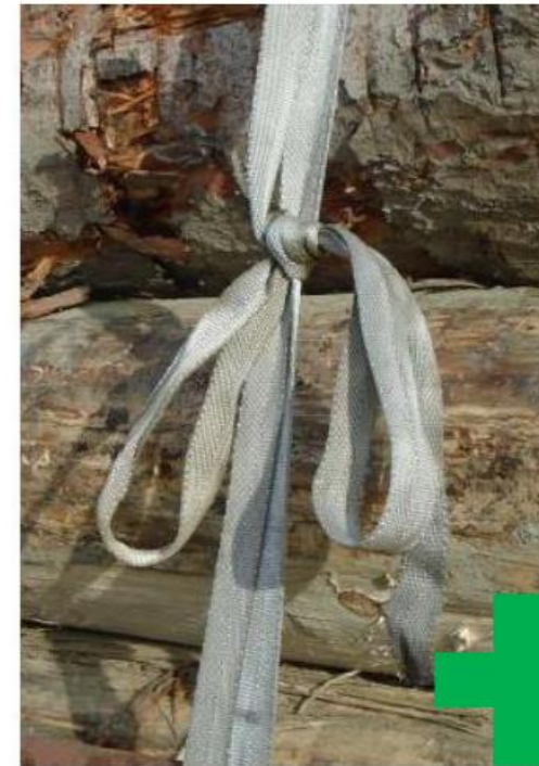
Obr. č. 37. Správne utiahnutý popruh do „UIC mašle“ Možnosť utiahnutia vozmajstrom pri kontrole v prípade uvoľnenia.
