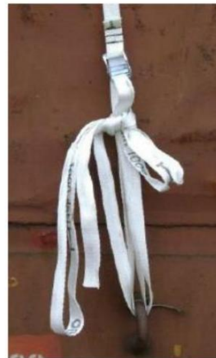
Obr. č. 37. Správne utiahnutý popruh do „UIC mašle“ Možnosť utiahnutia vozmajstrom pri kontrole v prípade uvoľnenia.
