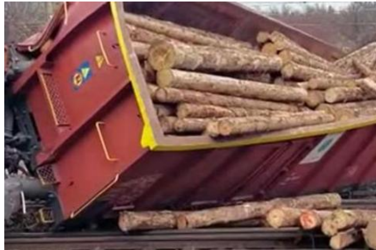
Vykoľajenie vozňov v dôsledku vypadnutia guľatiny, Rumunsko, rok 2021
