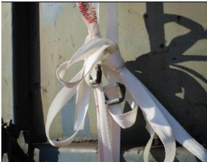
Obr. č. 36. Nesprávne zauzlený nevratný popruh. Nemožnosť dotiahnutia vozmajstrom v prípade uvoľnenia.
