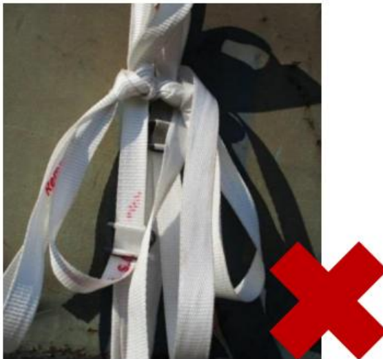
Obr. č. 36. Nesprávne zauzlený nevratný popruh. Nemožnosť dotiahnutia vozmajstrom v prípade uvoľnenia.
